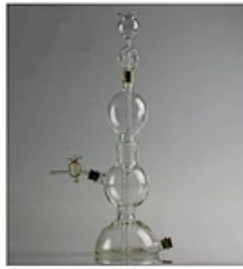
E22.1361 Gas Generator
